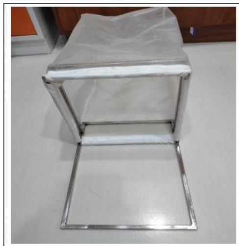
Gambar Model/Teknologi Alat Pengambilan Sampel Benthos Type Surber.Net
