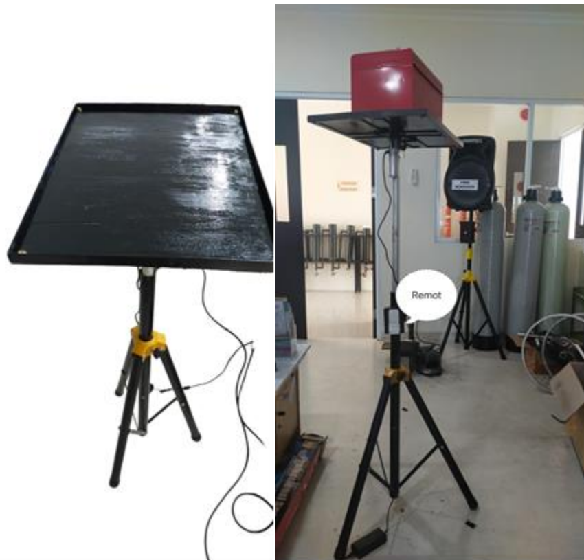
Gambar Model/Teknologi Meja Sampling Udara Ambient dengan As Drat Ulir sebelum dan setelah ditinggikan
